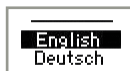
Выберите язык перед первым входом в меню. В течение первых 30 секунд после включения или позже в меню диагностики.
